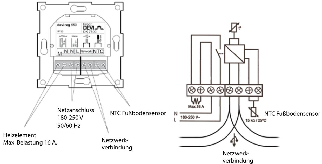
**7** Bei der Installation des **Devireg™ 550** wählen Sie die Art der Heizung und den dazugehörigen Sensor aus.
